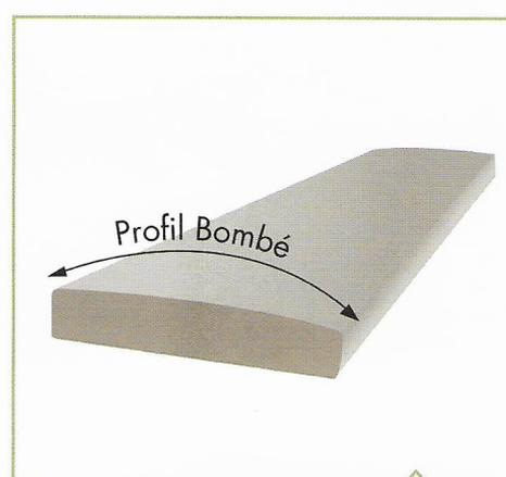
Usinage légèrement arrondi sur la face haute du platelage assurant un séchage rapide du bois. Compense également le phénomène de tuilage (cuvette).
